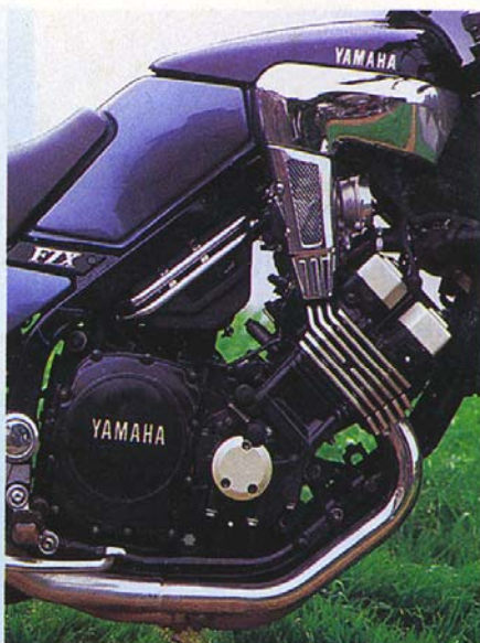
88 cv, quatre cylindres en ligne face à la route et 749 cm 3 , telles sont les caractéristiques du Fazer qui prend des tours comme une turbine, mais cette facette sportive ne s'accorde pas toujours à une partie-cycle tranquille.
