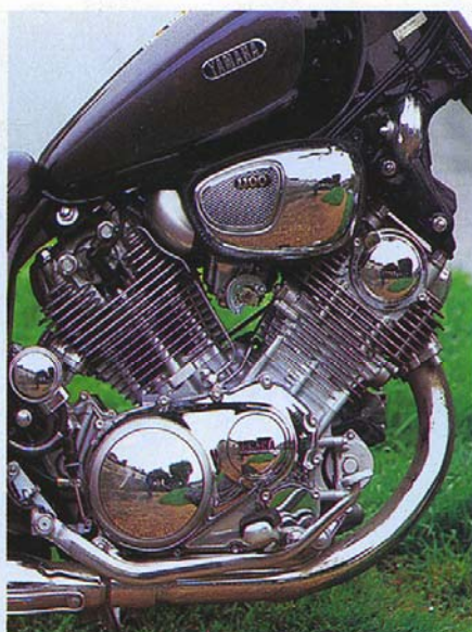
Le gros V-Twin de 1063 cm 3 , transmet par l'intermédiaire de son cardan ses 62 cv et surtout ses 8,7 mkg de couple. L'allonge et le coup de piston sympa sont au rendez-vous, tout à fait dans le style "custom". Une réussite.
